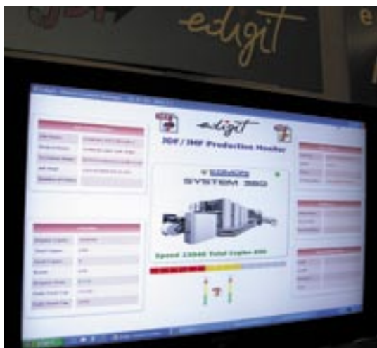
L'interfaccia del sistema Edigit che rileva in automatico i dati dalla produzione nel formato JDF
